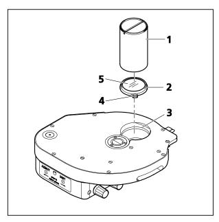
Fig. 3-14 DIC-Prisma im Modulatorrevolver wechseln
