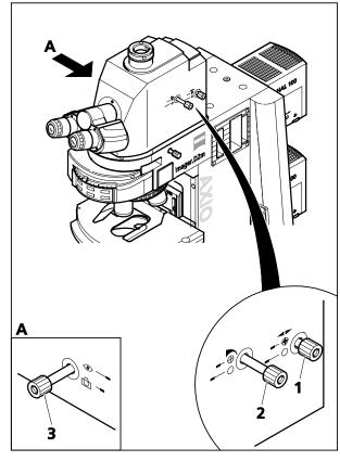
Fig. 4-126 Axio Imager mit montiertem Fototubus Pol
